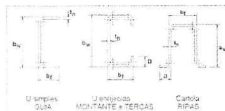
figura 1 - Perfis típicos para uso em Steel Frame - “U simples”, “U enrijecido” e “cartola”
